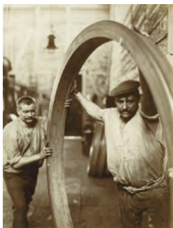
Transport nahtloser Radreifen, 1899
